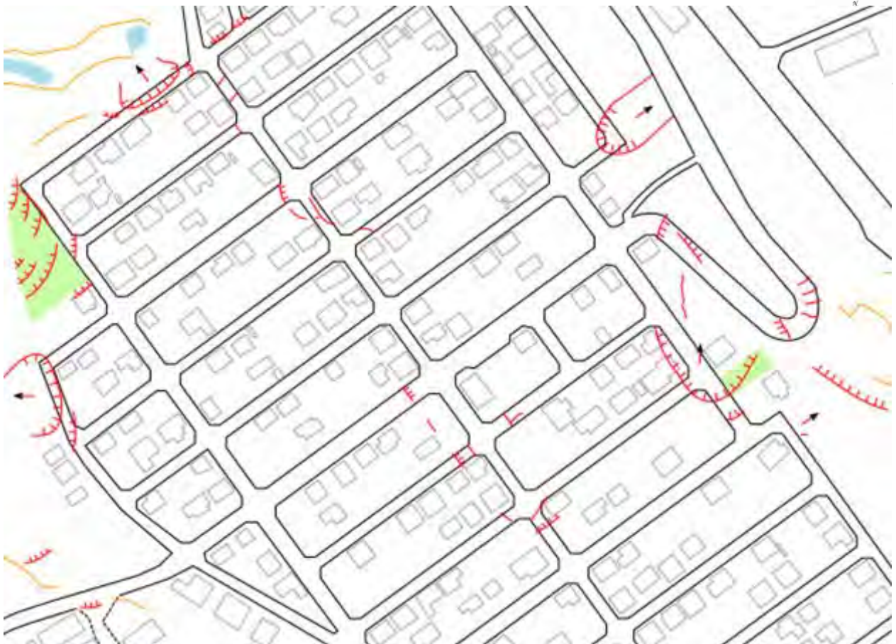
図－3.14.1 亘理郡山元町 A 団地の亀裂分布図 (S=1:2,500) (地形図出典：Yahoo Japan HP より)
