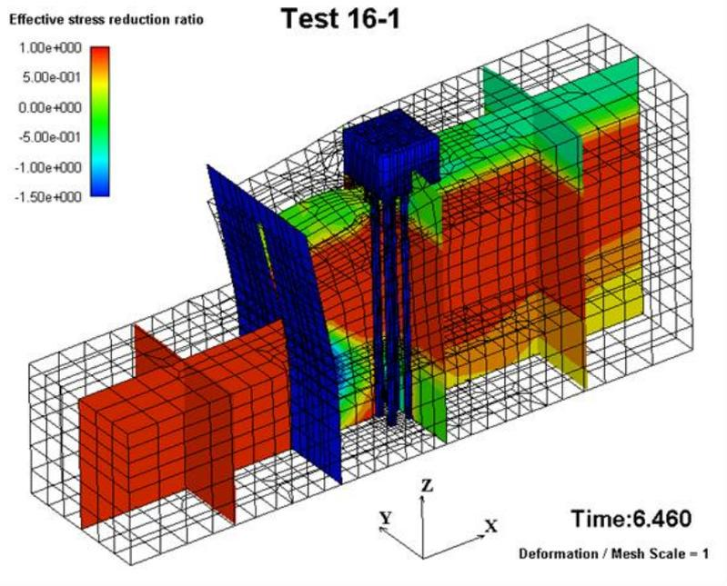
口絵写真-3 加振後の変形図と有効応力減少比 (ESDR =  $(\sigma'_{mo} - \sigma'_m) / \sigma'_{mo}$ )
