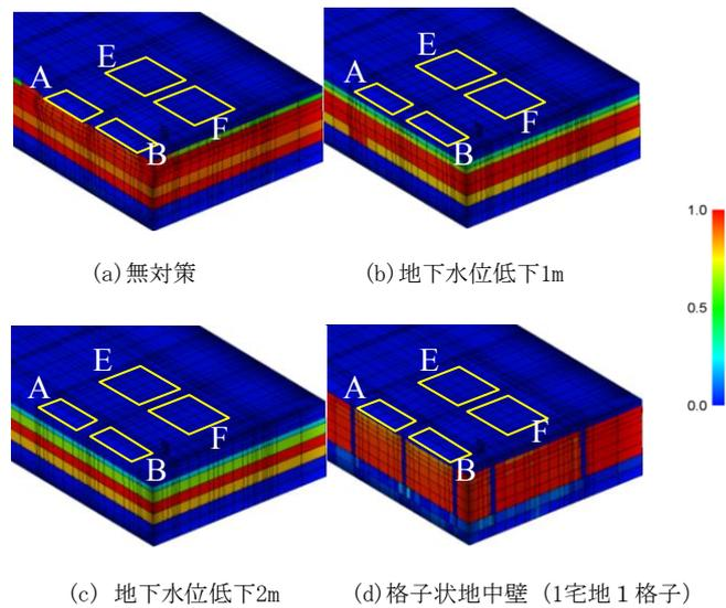
口絵写真-4 加震終了時(60sec)の変形及び過剰間隙水圧比、最大値は1.4(①-①断面)
