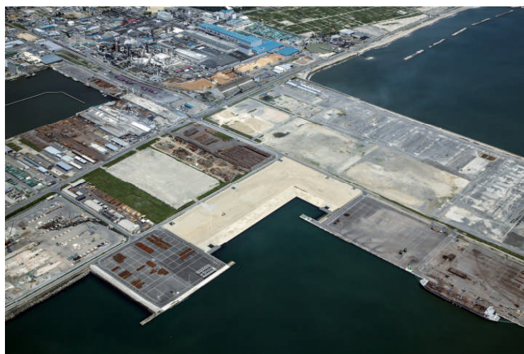
図-3.4 水面埋立の例（仙台塩釜港石巻港区における災害廃棄物等の海面処分場） 30)
