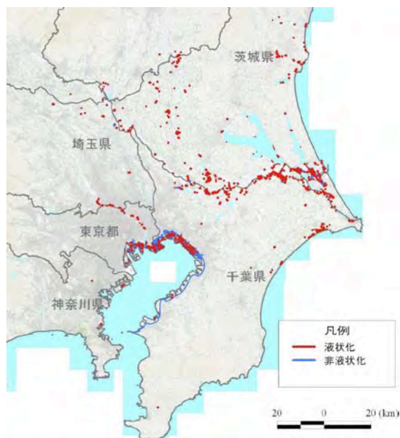
図-2.2.3 関東地方の液状化発生箇所 7)
