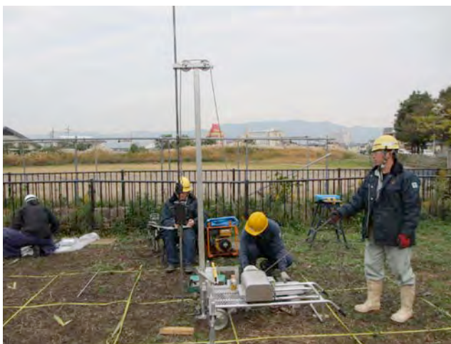
写真-3.3.14 DSPT 試験機
