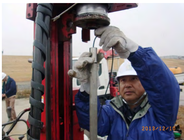
(a) マイク線引出し用治具の設置
