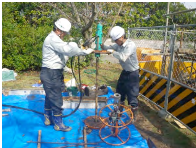
写真-3.3.21 手動式バイブロサンプラー
