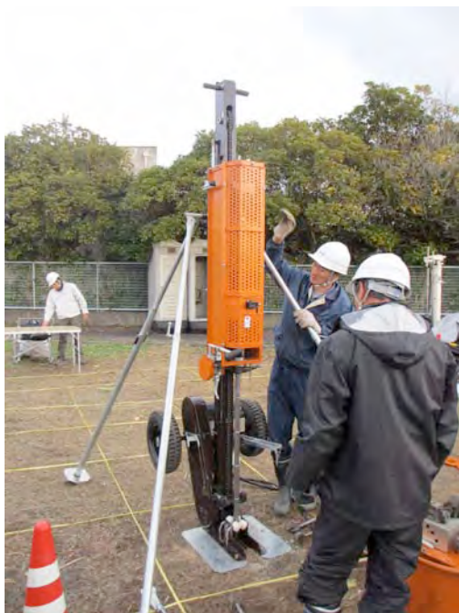
写真-3.3.4 SRS-O 試験機（半自動型）
