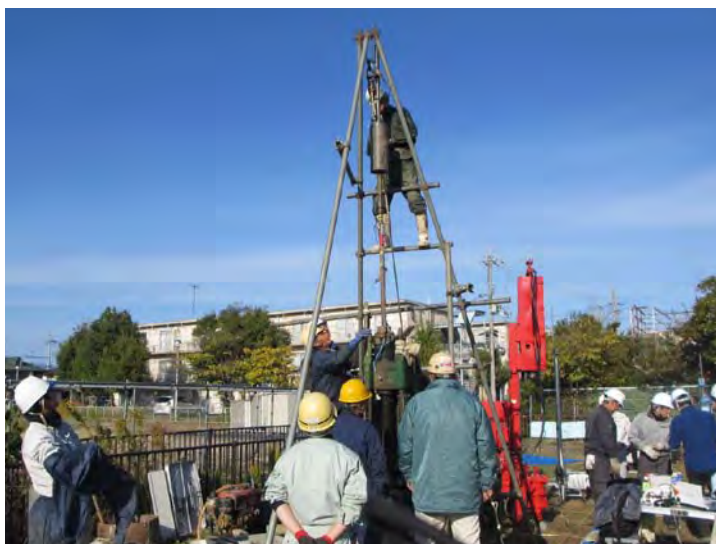
写真-3. 4. 6 Test 9 (SPT)の計測風景
