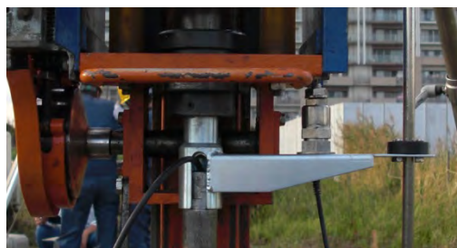
写真-3.3.8 トリガーの設置状況
