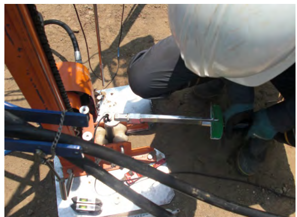
写真-3.3.10 トルク測定状況
