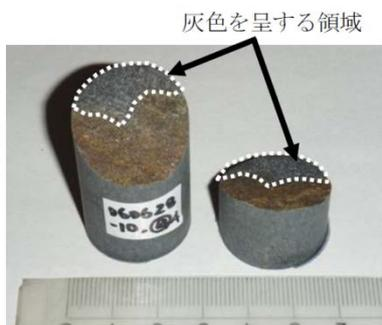
図-6.65 引張り試験によって生じた破断面の様子
