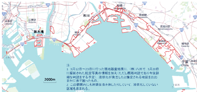
図 1 地盤に液状化が発生した推定範囲(安田進、原田健二) 図 2 地盤液状化による家屋・道路の被害(安田進)
