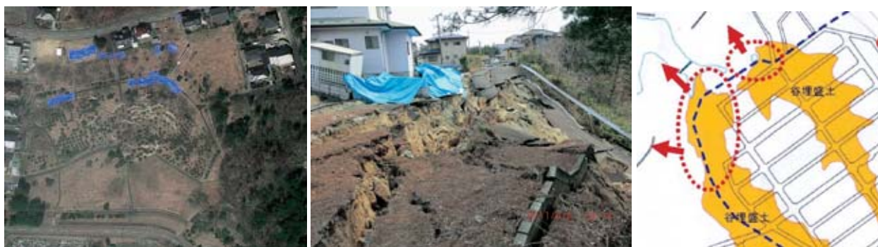
図4 宅地の基礎地盤の地震被害のメカニズムによるパターン分類
