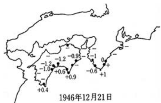
図10 過去の地震における高知付近の地盤の隆起と沈降(河角廣博士による、数値の単位 m)
