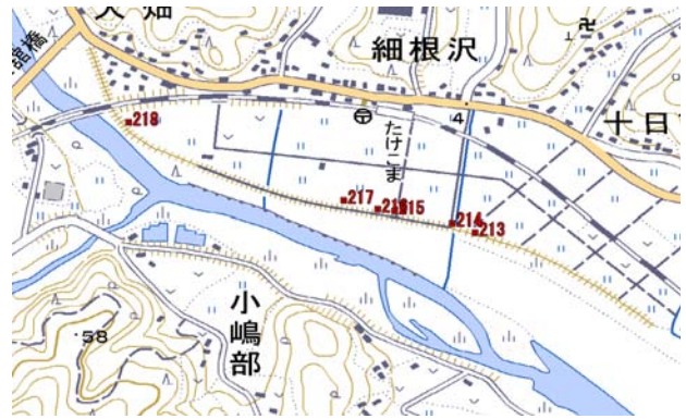
図-7 竹駒駅付近（■213：水路東側，■214：水路，■215：破堤，■216：堤体裏のり面の侵食，試料採取，断面計測，■217：破堤，■218：破堤）
