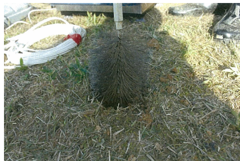
写真-3.2 ワイヤブラシによる試験面の整形 7)
