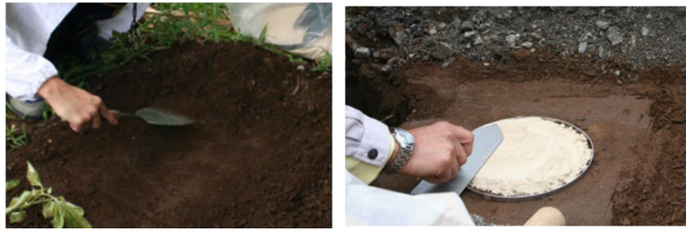
写真-3.1 均ぺい・整形の様子、ならびに金属リングの使用例
