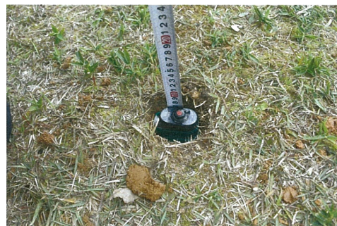
写真-3.4 小型カメラによる試験面の状態確認 7)
