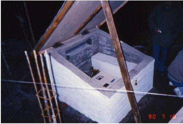
写真—9.16 Veta del Agua に設置した地震計
