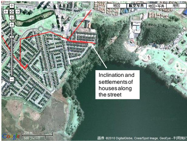
図-4.12 住宅の沈下と傾斜被害が発生した Bayona 地区
