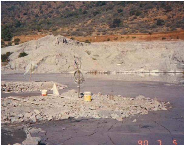
写真—9.17 Veta del Agua に設置した間隙水圧計
