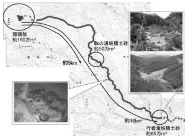
図 - 4 土石流の流下経路と推定堆積土砂量
