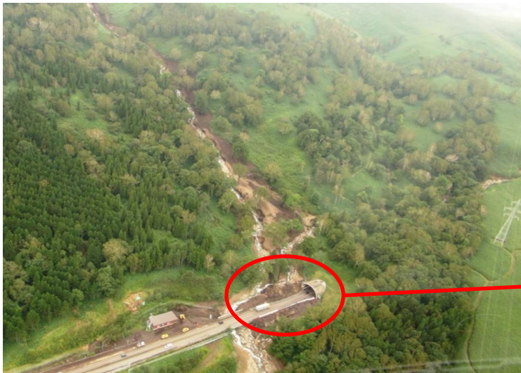
1段目の切土部が崩落し本線まで水が流れ込む
