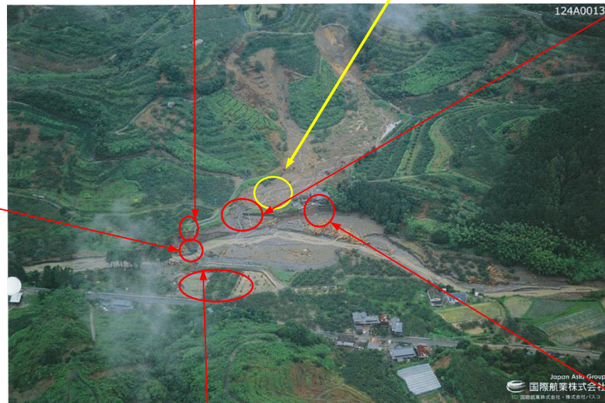
ため池右岸袖部に越流に伴う洗掘跡が確認される。
