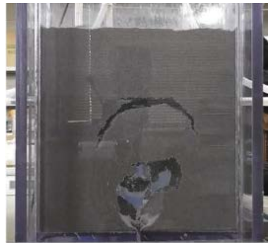
写真-2 地中空洞崩落・道路陥没発生に関する研究 (佐藤ら)
