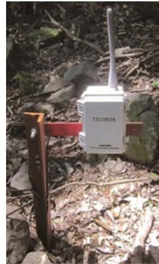
Figura 8 Sistema de bajo costo para el monitoreo de pendientes proclives a deslizamientos debido a precipitaciones: ejemplo de ingeniería geotécnica para la gente
