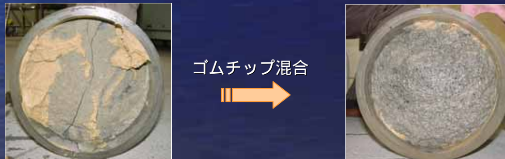
パンチングせん断試験 ( 20cm × t5cm 供試体底面の破壊状況)
