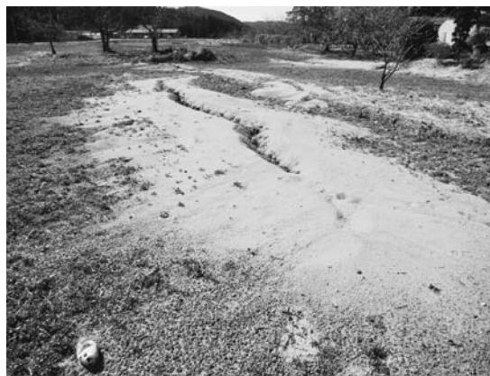
写真二 堤内地の液状化による噴砂とクラック（石巻市河南町北和淵、西八反崎）
