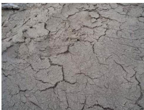
津波による堆積物は、地震発生から約 1 ヶ月が経過した調査時点では表層部分の多くが乾燥しており、写真のようなひび割れ状で分布していた。表層から約 4mm 厚で板状に乾燥収縮した堆積物が分布しており、その下部はシルト質～砂と見られる堆積物が存在していた。
