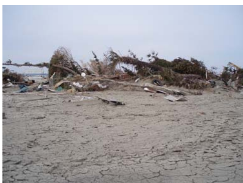
津波による堆積物は、地震発生から約 1 ヶ月が経過した調査時点では表層部分の多くが乾燥しており、写真のようなひび割れ状で分布していた。表層から約 4mm 厚で板状に乾燥収縮した堆積物が分布しており、その下部はシルト質～砂と見られる堆積物が存在していた。
