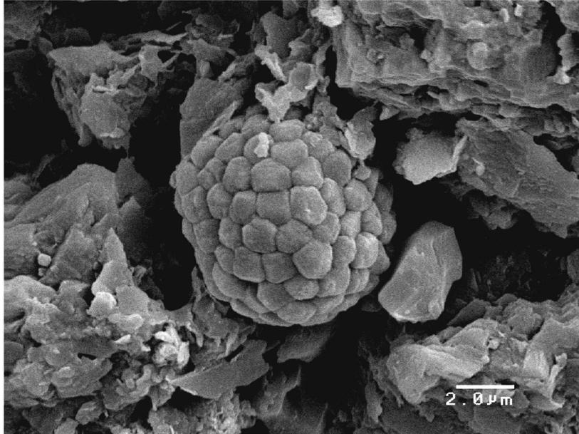
口絵写真-14 黄鉄鉱(パイライト,  $\text{FeS}_2$ )の電子顕微鏡写真
