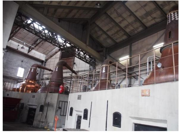
口絵写真—36 余市蒸留所の単式蒸溜器（ポットスチル）
