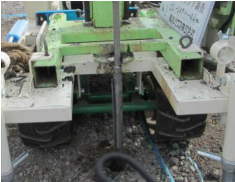
(3) 開閉貫入式サンプラーの SWS 試験機へのセット状態
