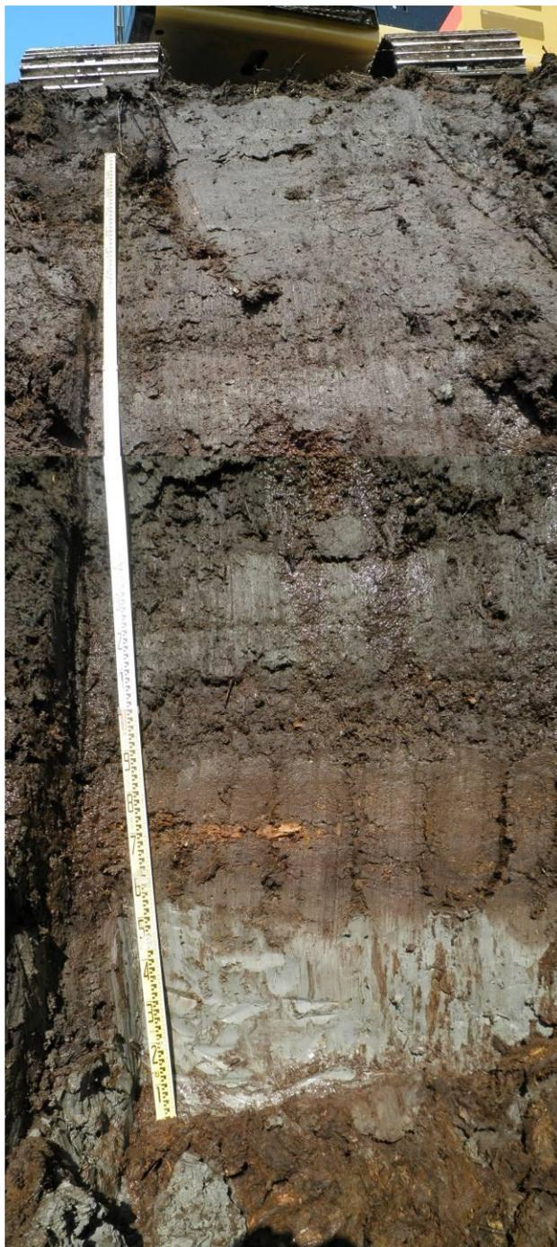
口絵写真-3 石狩川下流域における泥炭層の試掘断面
