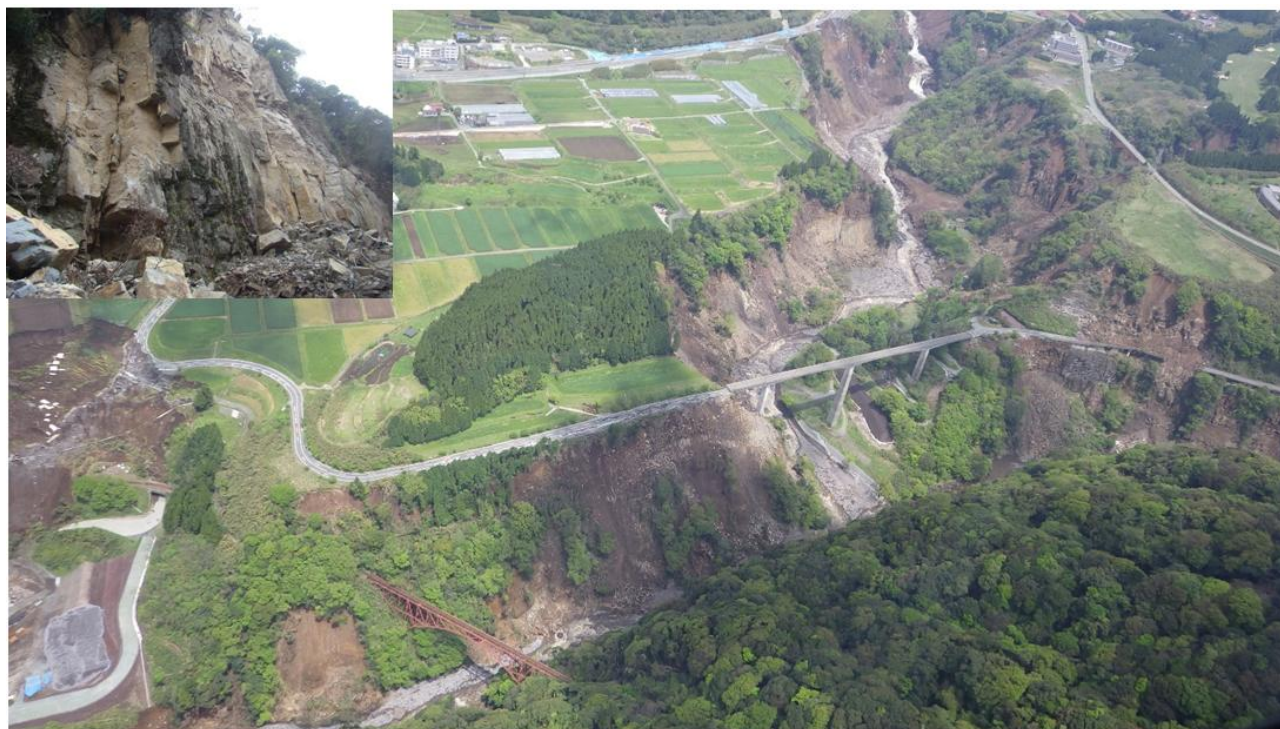
口絵写真-2 落石・トップリング・岩盤崩壊(黒川・白川兩岸, 撮影：九州大学大学院 安福規之教授)
