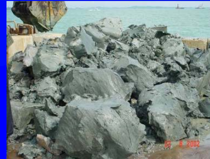
埋立材としての浚渫粘土塊 (lumpy clay)
