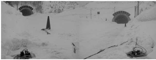
(a) 西側出口付近 (b) 東側出口付近 写真-3.1.6 常時微動計測状況(焼石トンネル)
