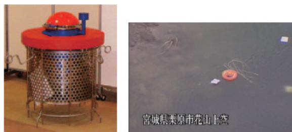
写真 - 6.3.1 投下型水位観測ブイの外観(左) および設置後のブイ浮上状況(右) 17)
