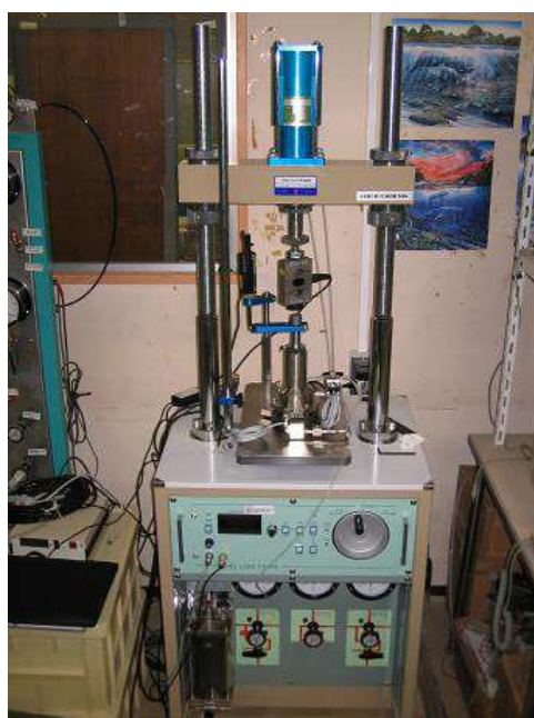
図 8 SUS316L 製定ひずみ速度圧密試験装置
