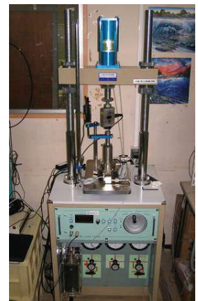
図 2 SUS316L 製定ひずみ速度圧密試験装置
