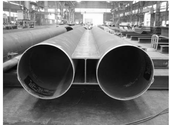
写真-2.5.4 連結鋼管矢板
