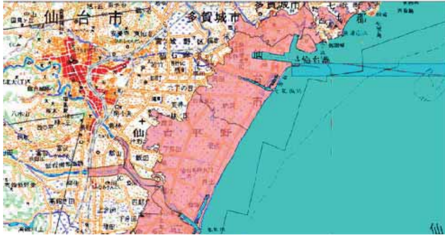
図 3-22 仙台平野の地盤の浸水地域 (国土地理院による)
