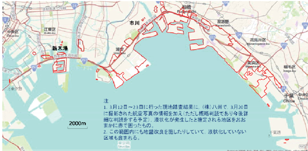
図 3-16 推定した地盤の液状化が発生した範囲(安田進・原田健二)
