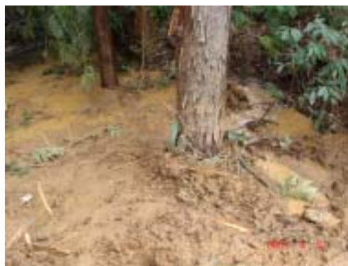
図-9 崩壊部先端付近の杉の幹の泥跳ね
