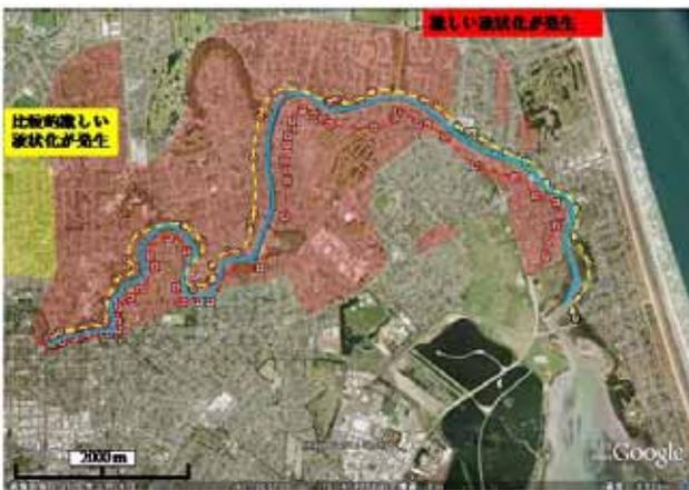
図 6-4.3 Avon 川沿いの側方流動影響範囲と液状化発生箇所
