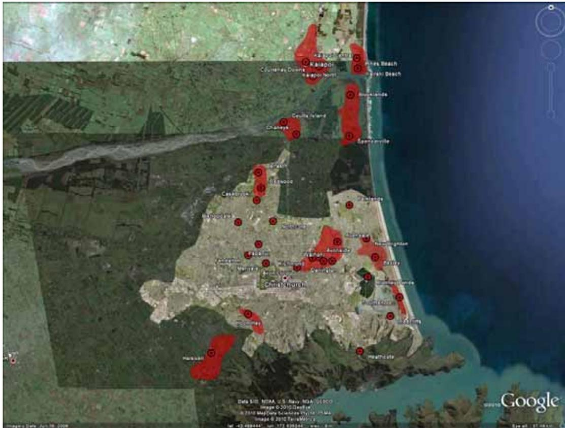
図—5.3 Darfield 地震における液状化被害マップ<sup>2)</sup>
