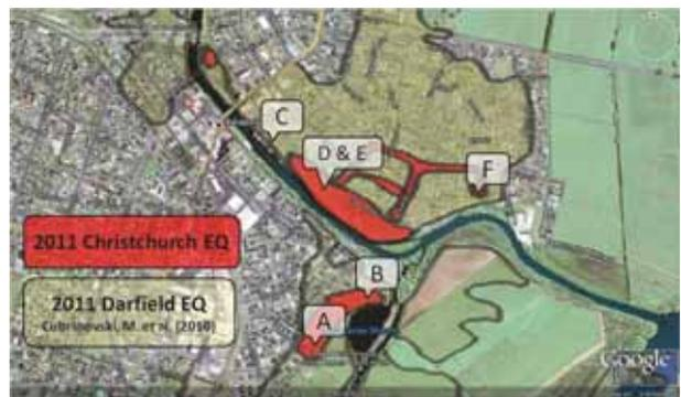
図 8.3 Darfield 地震および Christchurch 地震における液状化発生範囲<sup>4)</sup>の比較。(図中のアルファベットは追加被害を調査した地点)
