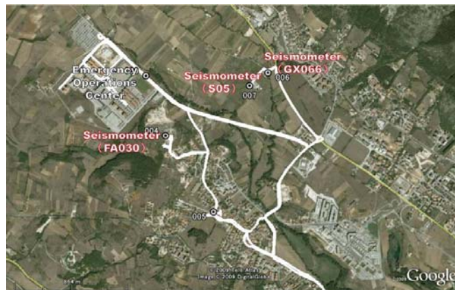
図-13 調査した強震計の設置位置
