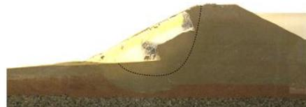
写真4.3.5 法尻からの進行的なすべり破壊<sup>5)</sup>
