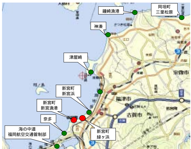
図 - 6.3 福岡市東部周辺で踏査を実施した地点と液状化地点（赤丸の地点でのみ噴砂跡を確認、緑丸の地点では噴砂跡を確認できず）
