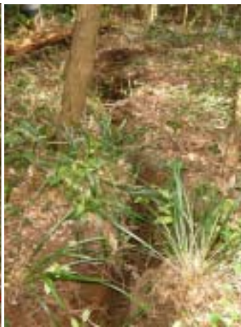
写真 - 3.18 Loc32606(2)西 東 N40°W 方向に伸びる第2列の開口亀裂
