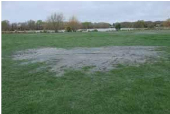
写真一付.10 Kaiapoi の河川敷（図-4.1 の Point 120 付近）におけるクラックと噴砂の発生状況
