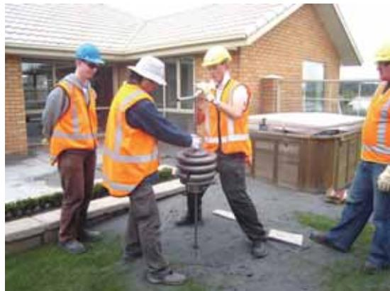
写真-3.26 Bexley の民家での SWS 試験 (図-3.12 の Point 93)
