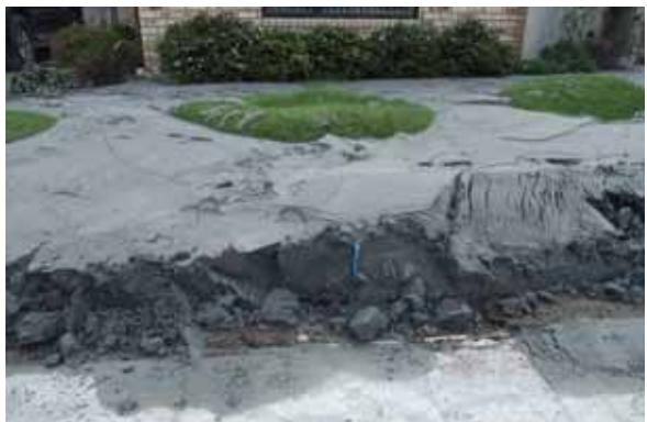
写真一付.6 Bexley の Seabreeze 地区(図-3.12 の Point 93 付近) で厚くたまっていた噴砂
