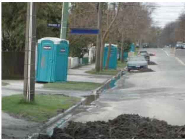
写真-2.4 道路に置かれた簡易トイレ。砂の山は住宅地から搔き出され、回収を待つ噴砂
