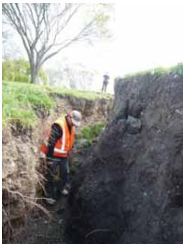
写真-4.4 クラック内で観察した堤体材料 (図-4.1 の Point
