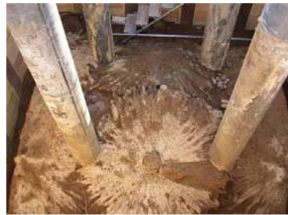
補強体の掘り出し状況 (実大実験)
