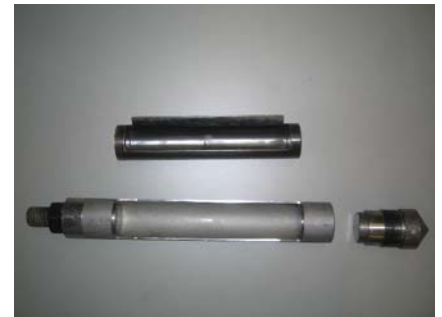
写真-1 SRS用サンプリング装置
