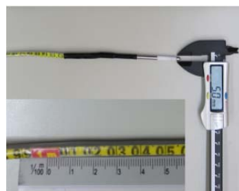
写真-3 センサーとメジャーケーブル (φ5mm)
