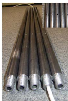
写真-2 有孔管 φ19mm (内径 7mm)
