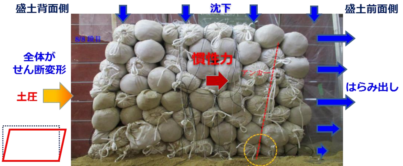
口絵写真-8 大型振動台を用いた加振実験における法先補強した盛土の土のう構造体 (プレストレス 50 \text{ kN/m}^2 ) (加振後にせん断変形が発生)
