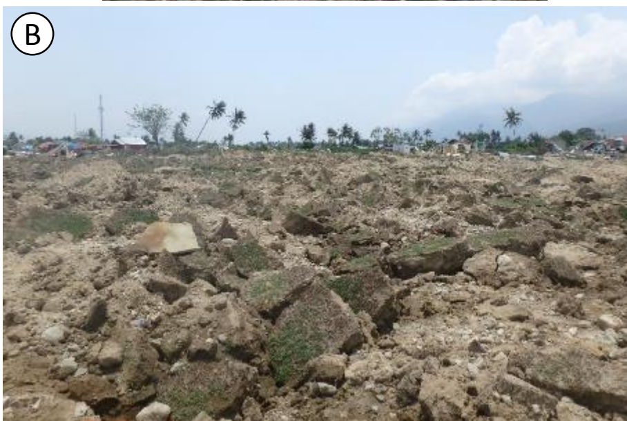
流動範囲の上部南側にあったグラウンドの一部と思われる土塊が数10cmのブロックとなって散らばる。流動距離は200m程度
