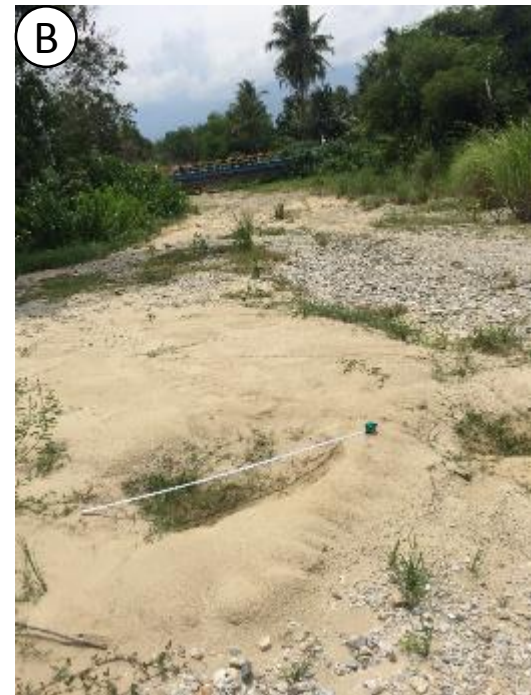
流動の中部、北側の境界、上流の水無川の延長である。大きな噴砂の跡が確認される。今回の調査で最大級の噴砂孔
