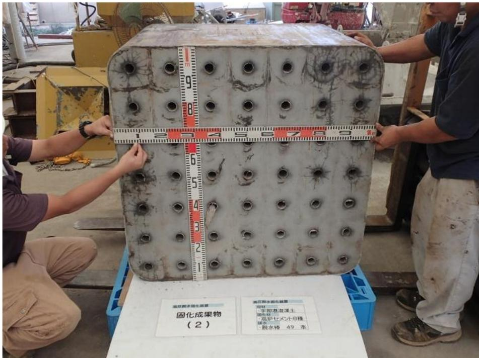
口絵写真-2 製造した浚渫土砂ブロック（体積：1m<sup>3</sup>）
