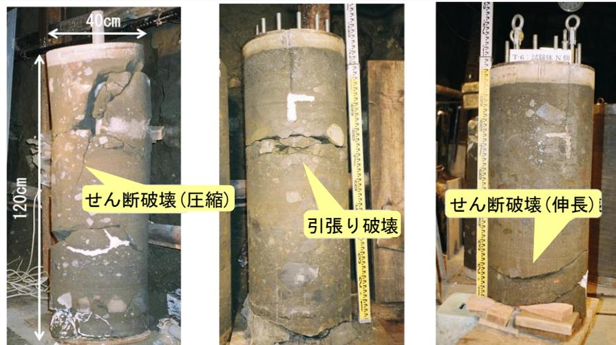
三軸圧縮 ( $\sigma_c = 1.0 \text{ MPa}$ )    三軸引張り ( $\sigma_c = 2.0 \text{ MPa}$ )    三軸引張り ( $\sigma_c = 4.5 \text{ MPa}$ )
