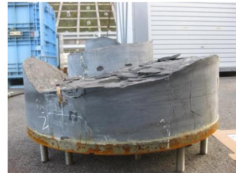
破壊した中空円筒の供試体
