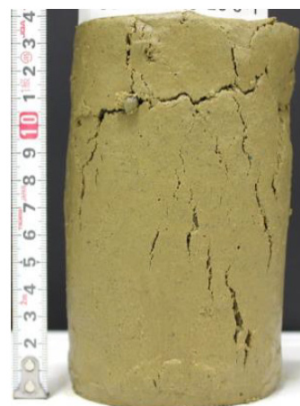
-20℃供試体の強度試験状況
