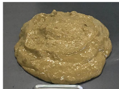
掘削土と加泥材の混合状況
